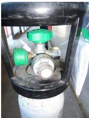
**Bombola di gas-farmaco O<sub>2</sub> dotata di gruppo valvola-riduttore e sistema di protezione tipo tulipano, gas identificabile dal foglio illustrativo sempre allegato**
